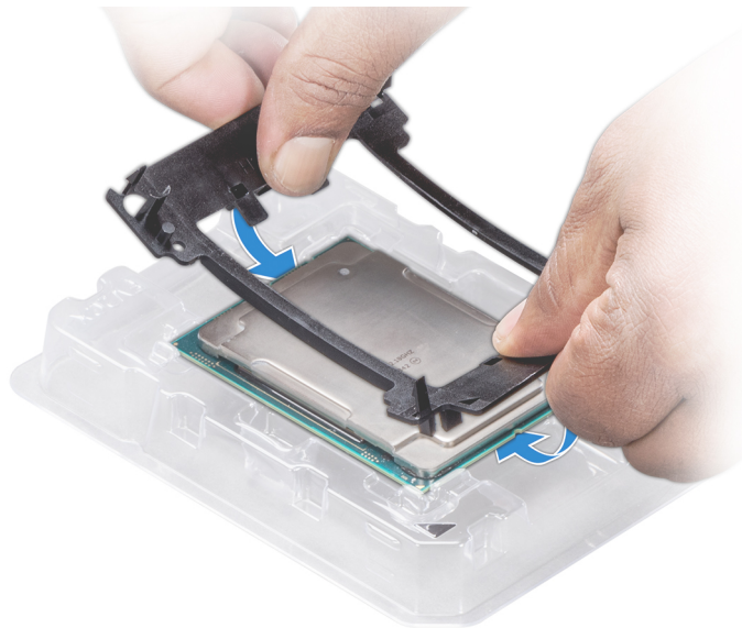
Figura 43. Instalación del soporte del procesador
