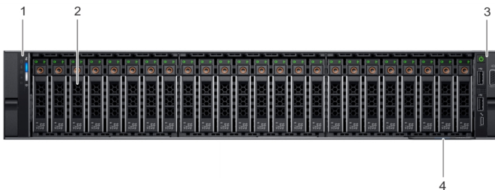
Figura 2. Vista frontal del sistema de 24 unidades de disco duro de 2,5"
