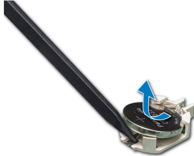
Figura 67. Extracción de la batería del system
